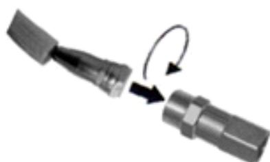
Rimuovere i cappucci protettivi dai semigiunti e avvitare manualmente le metà femmina di accoppiamento (sulle linee del refrigerante) sui semigiunti del componente o del dispositivo.
